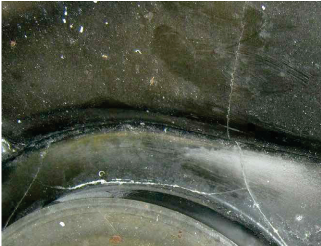
Bild 1: Druckguss-Formeinsatz mit Rissen.
