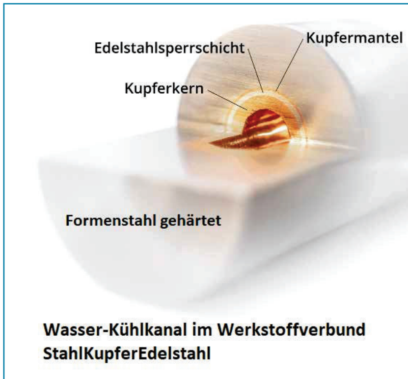
Bild 2: Wasser-Kühlkanal StahlKupferEdelstahl.
