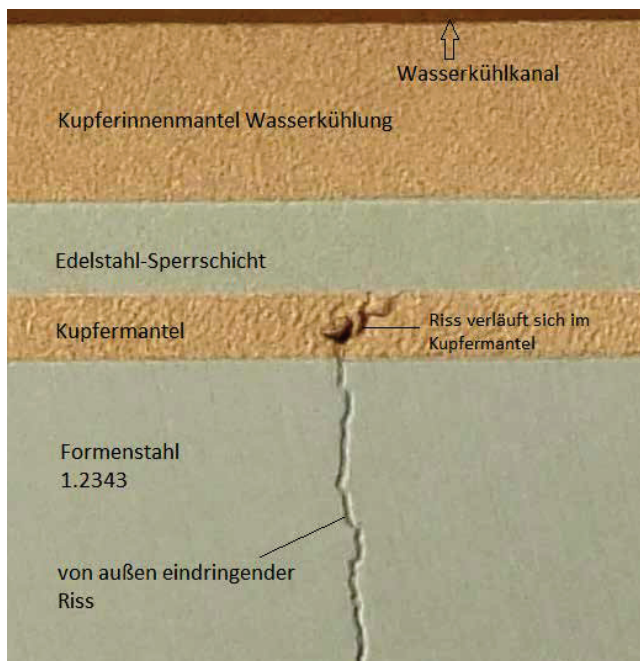
Bild 7: Rissabsorption im Formeinsatz durch Edelstahl-Sperrschicht.
